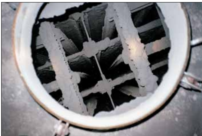
Nach sechs Wochen Produktion ohne Schallreinigung. Staub-Emission 29.4\text{mg}/\text{Sm}^3
